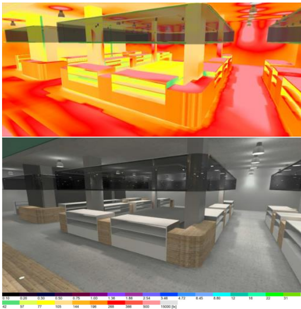
Рис. 4. Результаты светотехнических расчетов в программе DIALux
