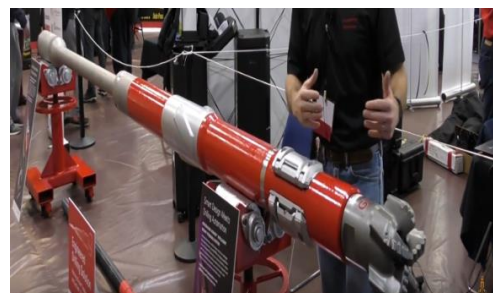
ნახ. 3. კომპანია ჰალიბურტონის მიერ შემუშავებული გონიერი ბრუნვითი მართვადი სისტემა iCruise (RSS)
