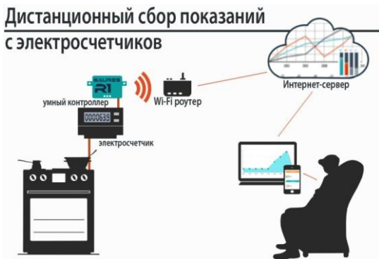
ნახ. 1. დისტანციურად ჩვენებების აღება მრიცხველებისგან
