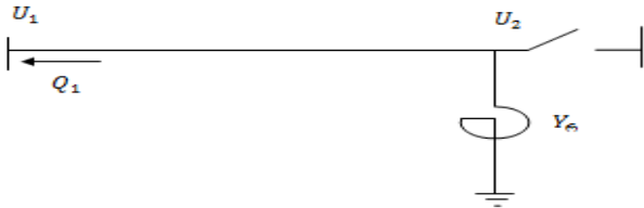
ნახ. 2. ზემაღალი ძაბვის ხაზი ცალმხრივად ჩართვის რეჟიმში რეაქტიული სიმძლავრის კომპენსაციისას
