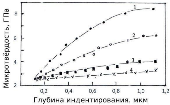
Рисунок. Зависимость микротвердости пленок ErSb напыленных на различных подложках от глубины индентирования:
