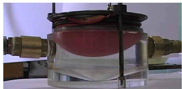
სურ. 2. აორთქლება კონდენსაციის ურთიერთშენაცვლე პროცესებით მომუშავე რეზინის დიაფრაგმიანი ტუმბოს ხედი მუშა სხეულის აორთქლების ბოლოს
