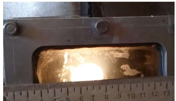
სურ. 3. ხურების ზედაპირის თავდაპირველი ვერტიკალური მდებარეობა (ზედა) და გადახრა დაახლოებით 800\ 000 \left[ \frac{[30]}{[2]} \right] -ის ტოლი ხვედრითი თბური ნაკადის ჩართვისთანავე (ქვედა)
