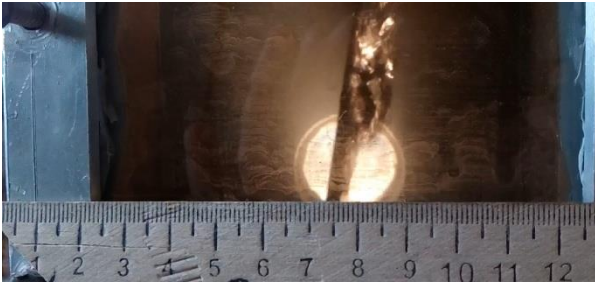
სურ. 4. ხურების ზედაპირის თავდაპირველი ვერტიკალური მდებარეობა (ზედა) და გადახრა დაახლოებით 300\ 000 \left[ \frac{\text{მტ}}{\text{წ}} \right] -ის ტოლი ხვედრითი თბური ნაკადის ჩართვისთანავე (ქვედა)
