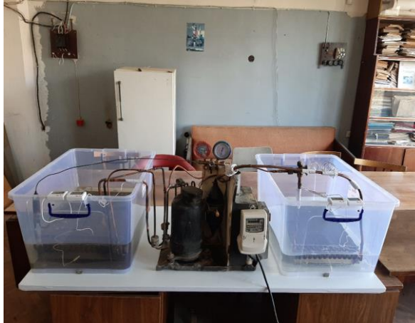
სურათი 1. ლაბორატორიული დანიშნულების თბური ტუმბოს ექსპერიმენტული დანადგარის მთლიანი ხედი.
