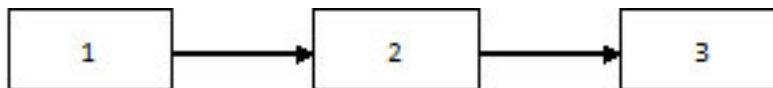
ნახ. 1. 1-პროტონების წყარო. 2-პროტონების ამჩქარებელი, 3-სინთეზის განსახორციელებელი დანადგარი და ენერჯის ტრანსფორმაციის ბლოკი.
