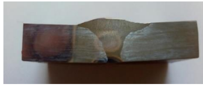
სურ.1.ფოლადი 08X25Г15C პირაპირა შედუღებული ნიმუში.
