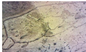
სურ.4. ფოლადი 08X25Г15C შენადული ნაკერის გარდამავალი ზონის მიკროსტრუქტურა: X 800, HV – 174
