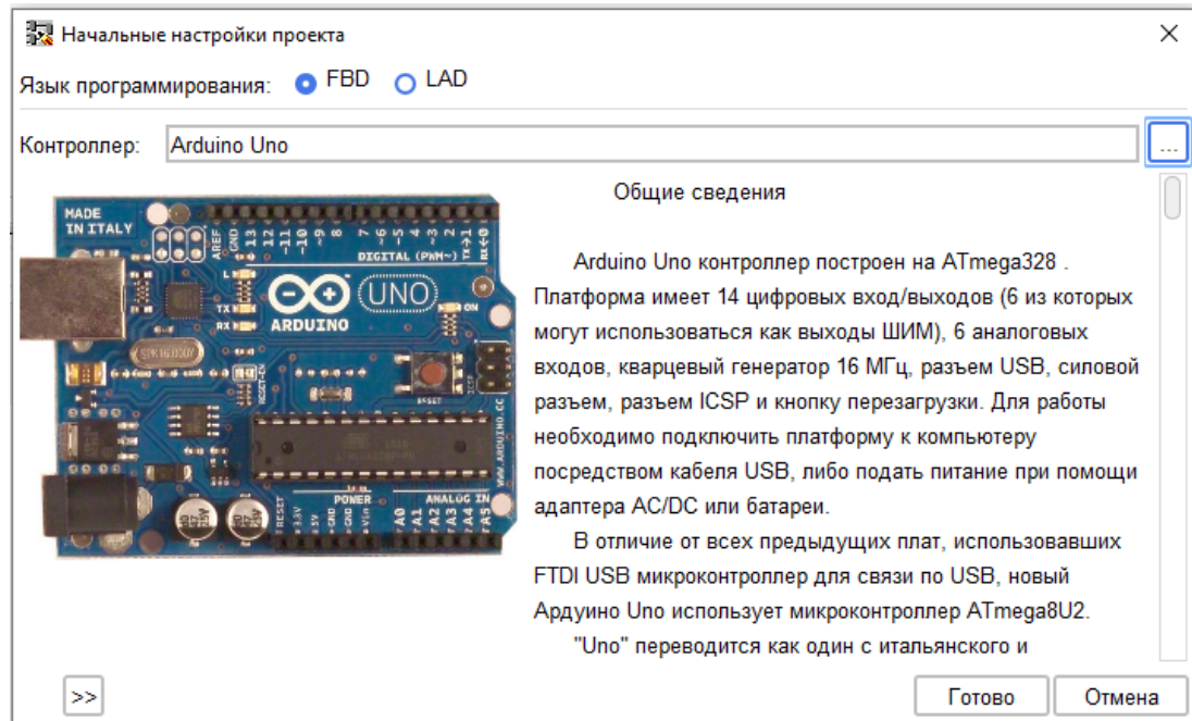
ფიგ. შ.4 Arduino Uno-ს გამოსახულება და მისი ტექნიკური მახასიათებლები
