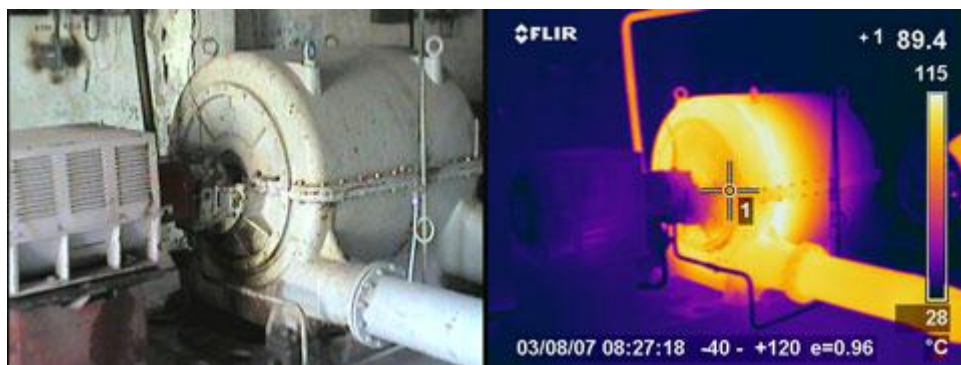
სურ.34. თბოგენერატორის თერმოგრაფული სურათი.
