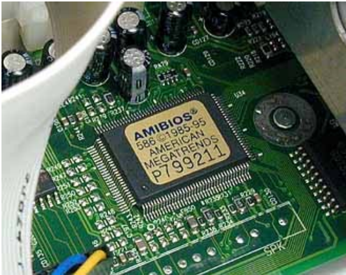
სურ. 7.1. სისტემურ პლატაზე დაყენებული მუდმივი მეხსიერების მიკროსქემა
