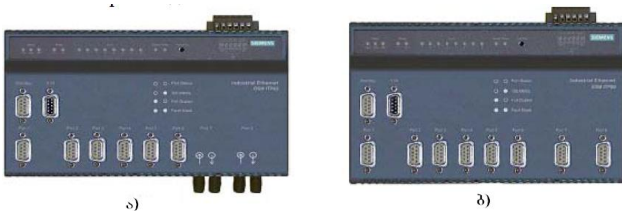
ნახ. 6.8. Fast Ethernet ქსელის კავშირის მოდულები: ა) OSM მოდული; ბ) ESM მოდული
