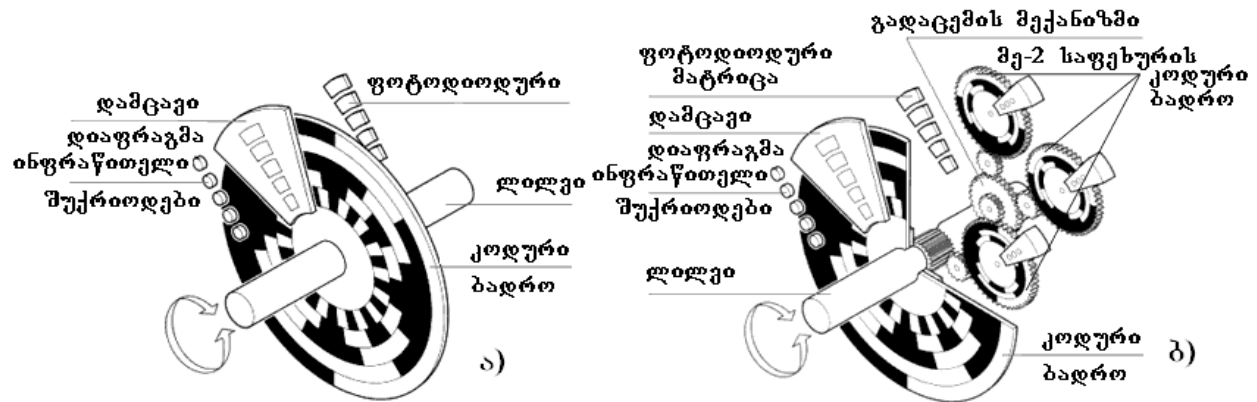
ნახ. 7.11. ერთბრუნვიანი ა) და მრავალბრუნვიანი ბ) ენკოდერების კინემატიკური სქემა
