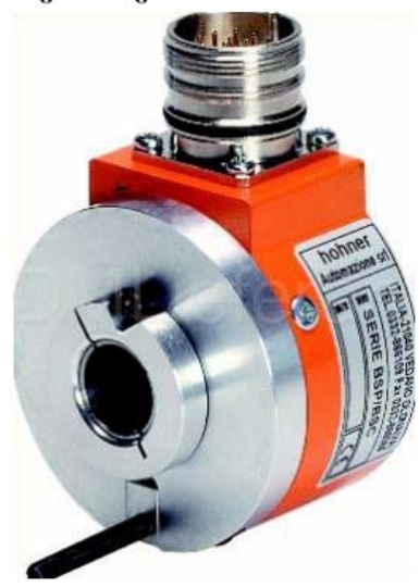
აბსოლუტური მრავალბრუნვიანი (4096 ბრუნვა) ენკოდერი 8192 მდგომარეობაზე
