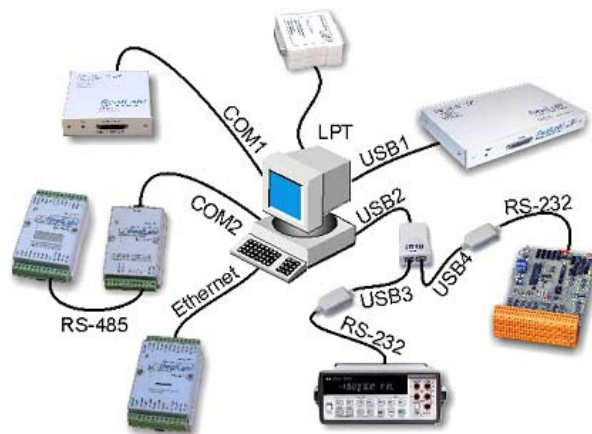
ნახ. 12. შემყვან/გამომყვანი მოწყობილობების შეერთებისათვის შეიძლება გამოყენებული იქნას კომპიუტერის (კონტროლერის) ყველა პორტი
