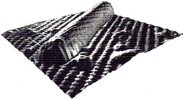
ნახ. 4.8. 10 \times 10 ნმ 2 ზომის, ერთკედლა ნახშირბადის ნანომილის სკანერული გვირაბული მიკროსკოპის ტოპოგრამის სამგანზომილებიანი გამოსახულება. ნანომილი შექმნილია ფიზასორბციული მეთოდით Si(100)-2x1:1H-ის ზედაპირზე მაღალი ვაკუუმის პირობებში
