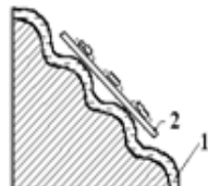
ნახ. 14.12. 1 - სარჩილის ტალღა, ტალღისებური ზედაპირიდან ჩამომდინარე; 2 - ნაბეჭდი ფირფიტა
