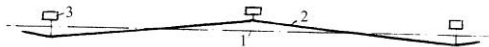
ნახ. 5.3. ლიანდავის ღერძის მიმართ საკონტაქტო სადენის ჩამოკიდება ზიგზაგურად. 1 – ლიანდავის ღერძი; 2 – საკონტაქტო სადენი; 3 – ფიქსატორი
