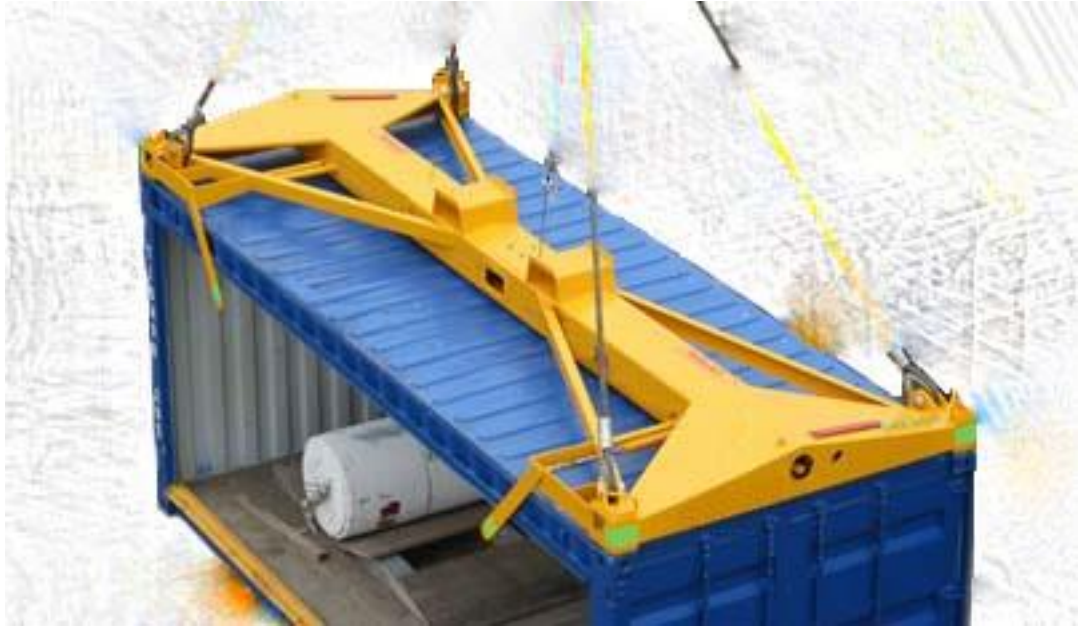
სურ. 14 მოდერნიზირებული ტრავერსა-სპრედერი 20' და 40' კონტეინერებისათვის
