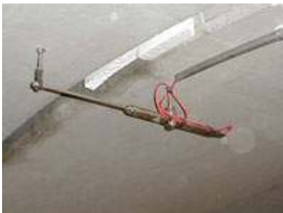
ნახ. I.32. ბზარის მზომი დამონტაჟებულია პირაპირის სტაბილურობის კონტროლისათვის
