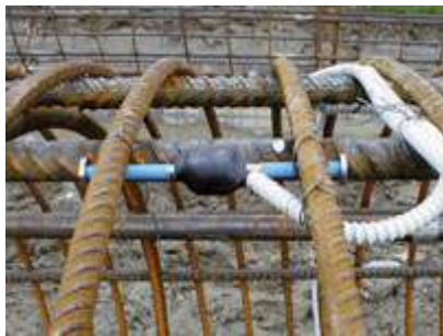
სურ. I.8. არმატურაზე დეფორმაციის ვიბრაციული მრიცხველის მონტაჟი
