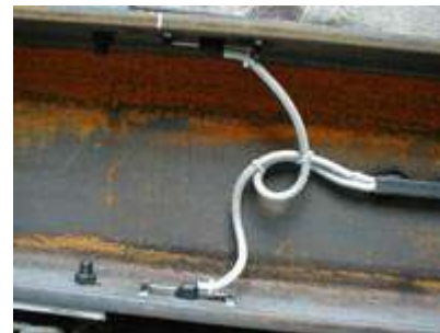
ნახ. I.33. ძაბვის ტენზომეტრული მრიცხველი, დამონტაჟებულია ლითონის კონსტრუქციაზე
