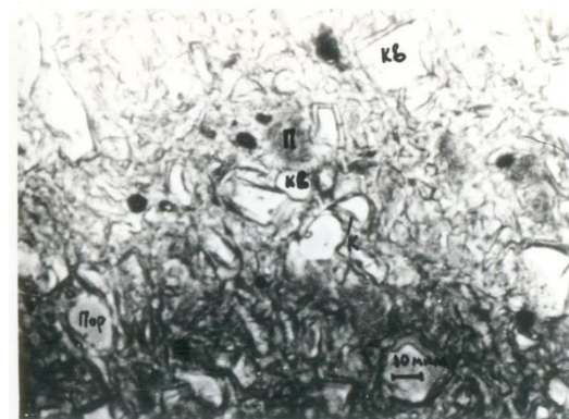
სურ.19. ძვლის ფაიფურის მიკროსტრუქტურა X 600
