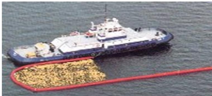
სურ. 7. დაღვრილი ნავთობის ლოკალიზაცია მატ-ბონის გამოყენებით
