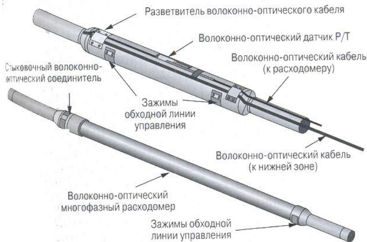
ნახ. 2. ორფაზიანი ხარჯმზომი და ოპტიკურ-ბოჭკოვანი \rho/T გადამწოდები შესრულებული, როგორც ერთი კომპლექსური კვანძები
