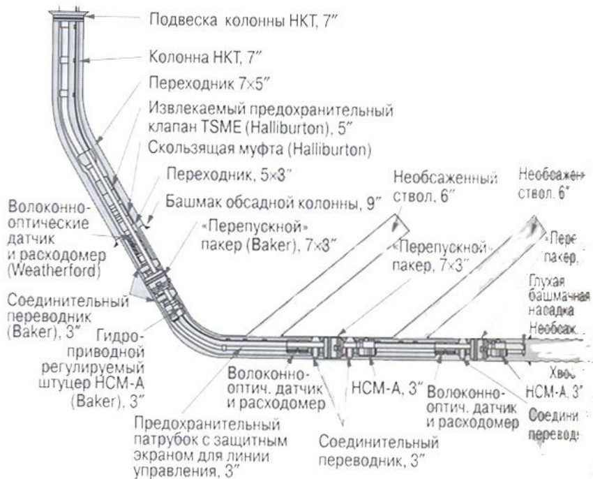
ნახ. 1. შემოდინების სარქველების რეგულირება ოპტიკურ-ბოჭკოვანი ხარჯმზომის და \rho/T გადამწოდის მეშვეობით, რომელიც დაყენებულია ცალკეული ლულის შესასვლელის მაღლა
