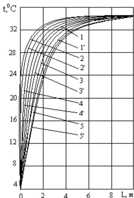
Рис. 3. Распределение температуры в окружающем массиве горных выработок:
