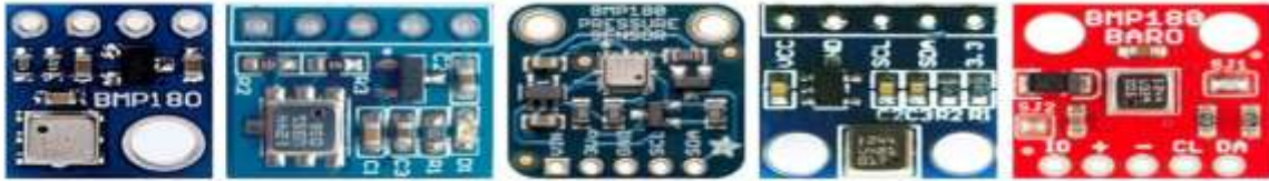
ნახ.3 BMP180 სენსორებზე აგებული ზოგიერთი მოდულის საერთო ხედიმ ელ.კომპონენტების განლაგებით
