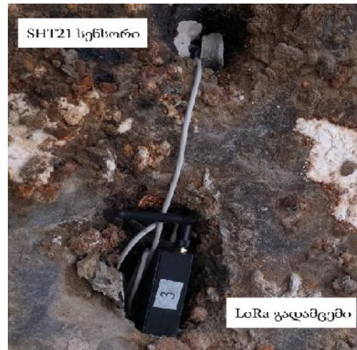
ნახ.7. UC3 წერტილი LoRa Ra-02 გადამცემი და SHT21 სენსორი
