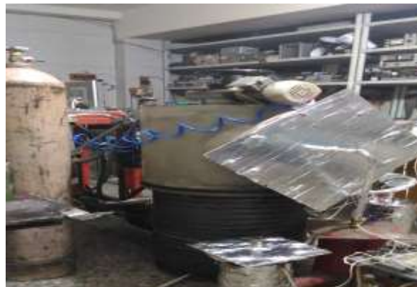
ნახ.4. სინთეზური საწვავის მიღების ექსპერიმენტული დანადგარის მოქმედი მოდელი
