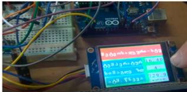
ნახ. 5. ატმოსფერული ინფორმაციის ასახვა Nextion HMI პანელზე
