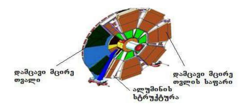
დამცავი მცირე თვალი - small sized protective wheel დამცავი მცირე თვლის საფარი - the cover of small sized protective wheel ალუმინის სტრუქტურა - aluminum structure
