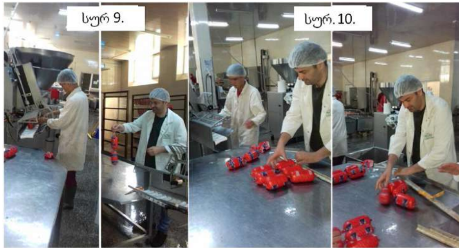
სურ. 9. კლიფსატორის დახმარებით ბატონების შეკვრა; სურ. 10. ბატონების ბიგებზე დაკიდების პროცედურა
