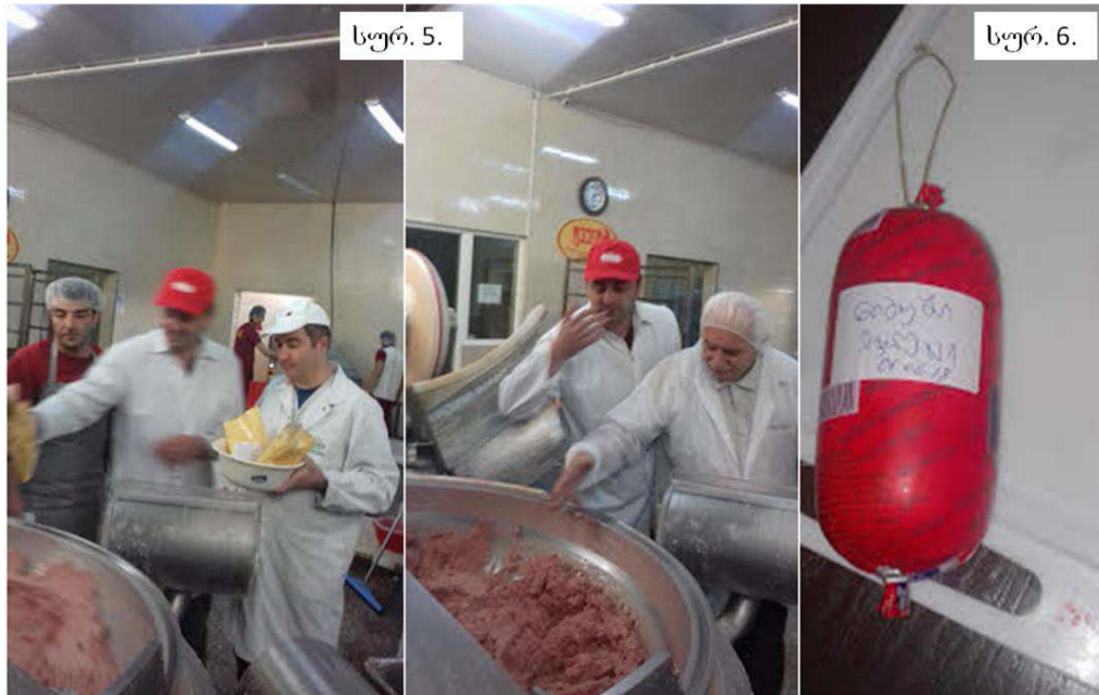
სურ. 5. კუტერ შემრევზე დანამატების შეტანა და ფარშის დამუშავება; სურ. 6. მცენარეული კონსერვანტით დამზადებული ძეხვის ბატონის ნიმუში
